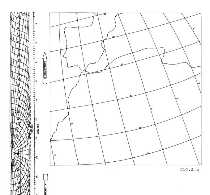
Fig.2.a: Verzerrung des geographischen Koordinatennetzes in einer APT-Aufnahme des Satelliten ESSA 6 (HAUPT, 1970:II-142)
