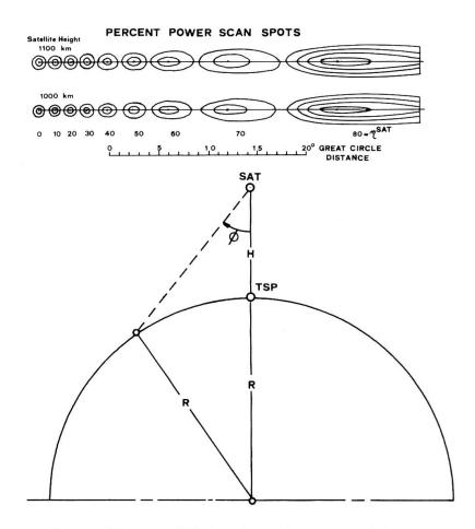
Fig.1: Berührungsfläche des Abtaststrahls eines Radiometers auf der Erdoberfläche aus 1000 und 1100 km Höhe als Funktion des Abtastwinkels  $\phi$ , bzw. der Grosskreisdistanz (H=Höhe der Satellitenbahn, R = Erdradius, TSP=Subsatellitenpunkt, Nadir) (Aus SCHENK,1973:65, verändert).
