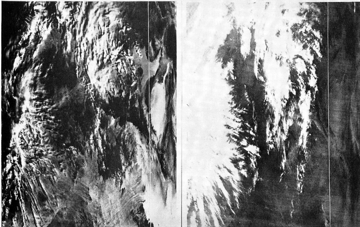
Abb.2a: Synchrone NOAA-2-Aufnahmen vom 21.10.1973, 8.54 GMT. Extreme Bedeckungsgrads-Unterschiede zwischen VIS-Bild (links) und IR-Bild (rechts). Aufnahme: Sternwarte Bochum.
