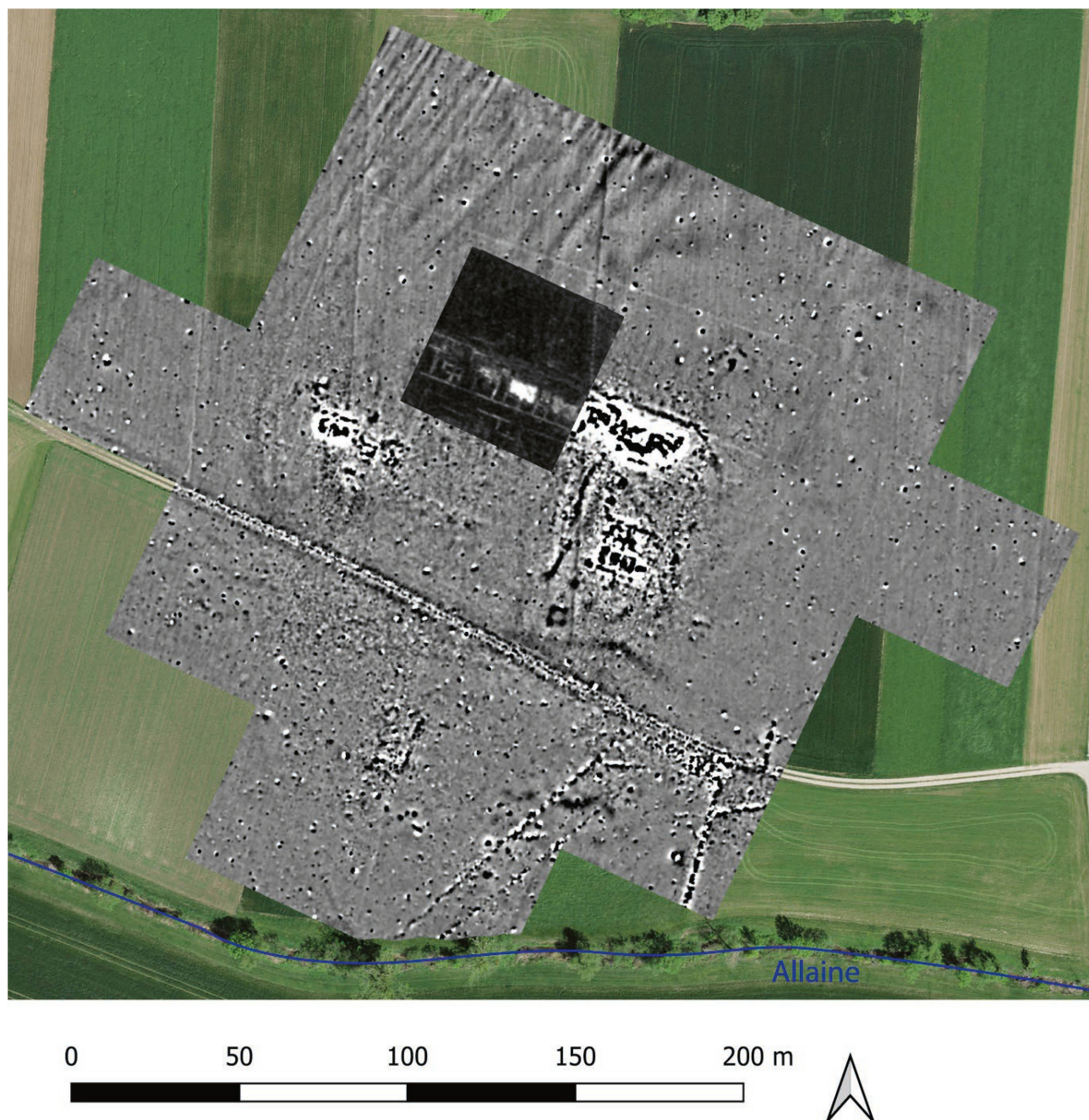
Abb. 3. La Baroche JU, Charmoille-Miserez. Geomagnetik- und Georadarprospektion der Fundstelle. Tiefenscheibe 50–70 cm. Kartengrundlage: Bundesamt für Landestopografie swisstopo, modifiziert Christian Hübner, GGH Solutions in Geosciences GmbH.
