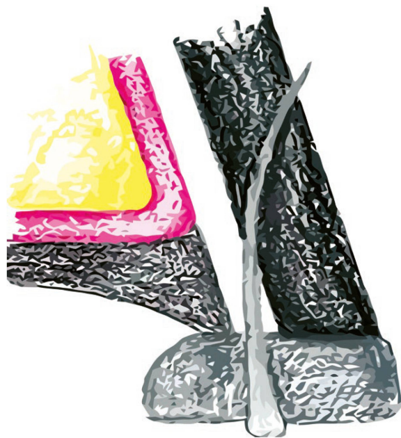
Abb. 4. Korrekte Position des Hufnagels. Zeichnung: L. Wetzel.
