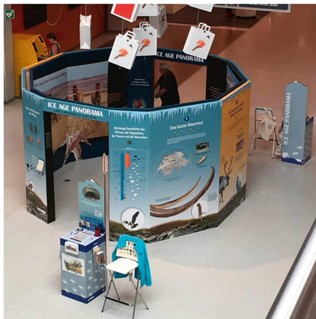
Fig. 1. Vue du panorama dans le centre commercial Gäupark, à Egerkingen SO. La structure de 4 m de diamètre et de 2.2 m de hauteur est composée de 24 cadres de bois sur lesquels sont agrafées des bâches imprimées, assemblés au moyen de vis. Une boîte à quiz est placée aux deux entrées du dispositif. Les présentoirs pour les feuilles de quiz sont accrochés sur les panneaux des entrées. Photo : auteur.e.s.
