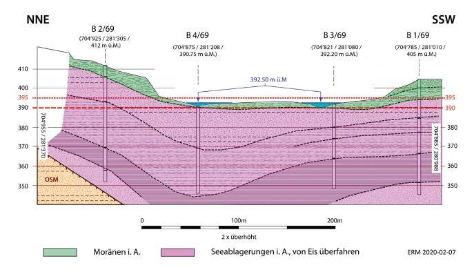
Abb. 13. Geologischer Profilschnitt durch den Rhein bei den Hemishofer Brücken. OSM=Obere Süsswassermolasse. Bearbeitet nach dem geologischen Bericht Nr. 2007 des Geotechnischen Büros Dr. von Moos AG, 1969. Plan Erich Müller.
