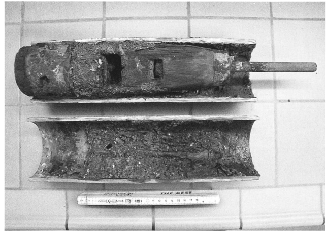
Abb. 71. Uzwil SG, Niederuzwil, Sonnmatt. Pumpmechanismus (Eisenrohr mit Holzkolben mit einfachem Lederventil) aus oberem Pumpenteil. Foto KA SG.
