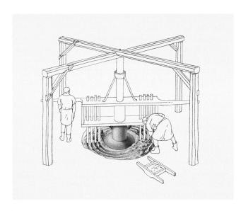
Abb. 14. Rekonstruktionsvorschlag Mörtelmischer HMA I bh. Grafik ABBS, H. Colombi.
