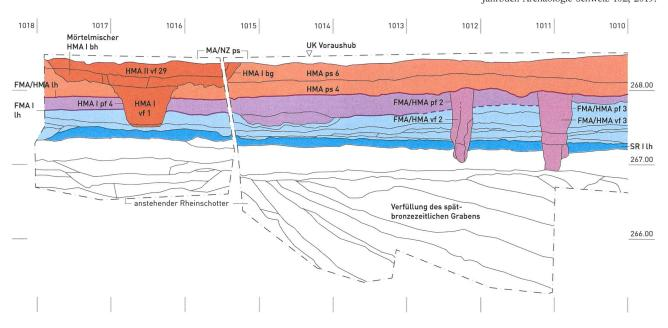
Abb. 13. Basel, Martinsgasse 6+8. Ostprofile Flächen 2l, 2b, 2d, 3e und 3b, Schnitt durch den Mörtelmischer HMA I bh und zwei Pfosten des Sechspfostenspeichers FMA/HMA ge. M 1:50. Grafik ABBS, P. von Holzen.
