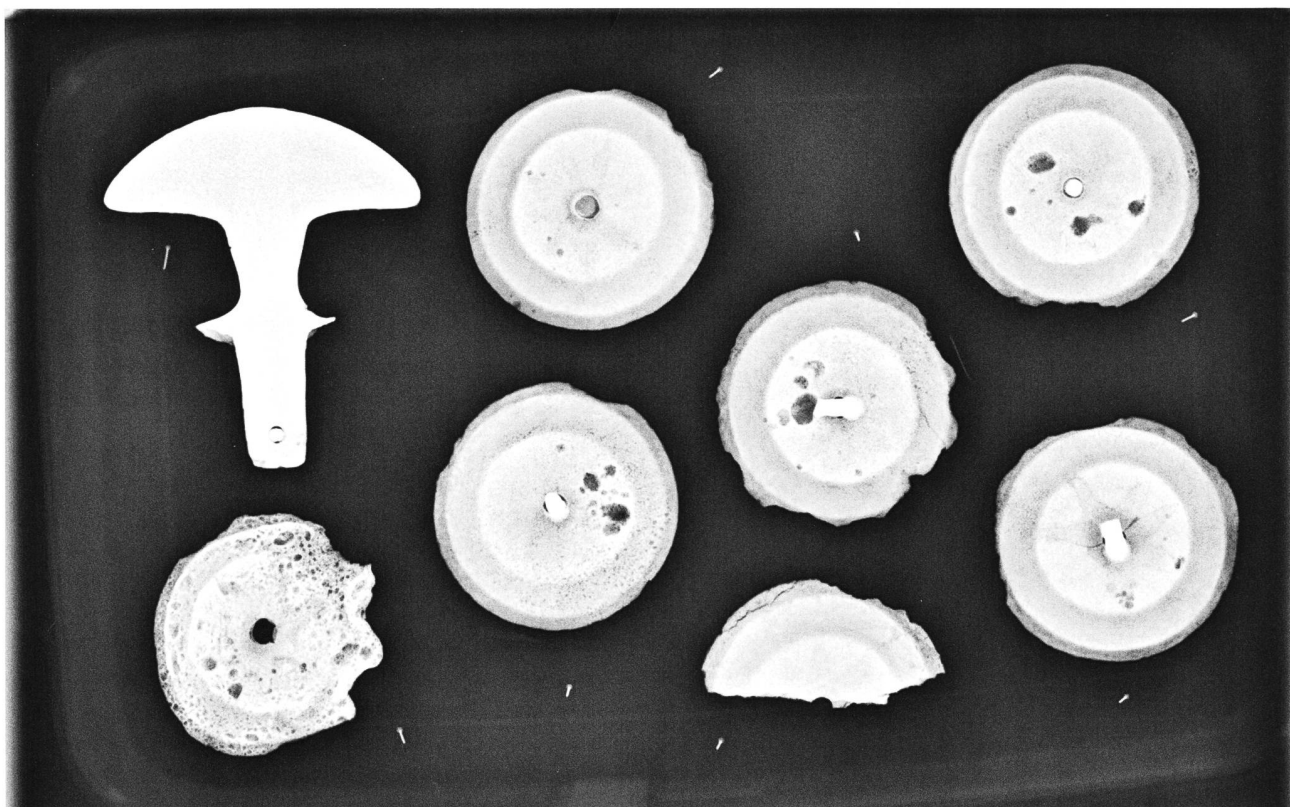
Abb. 27. Kaisten AG, Bronzekomplex. Röntgenbild der verzierten Objekte (Steckaufsatz [links oben] und Nagelscheiben) 0.260\text{dGy}\cdot\text{cm}^2 . Die Porosität der Nagelscheiben ist ein Hinweis auf ihre Herstellung durch Guss. Röntgenbild CIM SA, La Chaux-de-Fonds.
