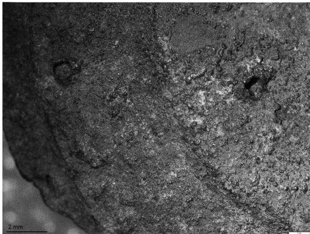
Abb. 34. Kaisten AG, Nagelscheibe Kat.-Nr. 1. Unregelmässige Oberfläche mit Blasen. Foto HECR Arc, G. Liengme.
