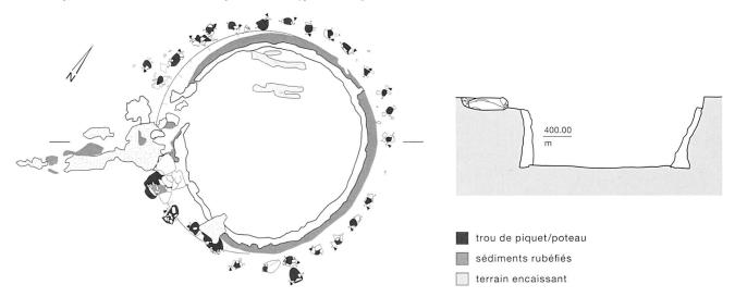
Fig. 23. Boncourt JU-Grand'Combe. Four à chaux mis au jour en 2001, entouré de 27 trous de poteau qui témoignent de la présence d'un clayonnage soutenant le manteau argileux. Éch. 1:100. Dessin/DAO Section d'archéologie et paléontologie du Jura, L. Petignat Häni.
