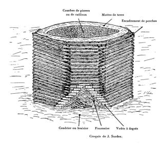
Fig. 26. Four à chaux entouré d'un caisson polygonal. Tiré de Surdez 1947, ETH-Bibliothek, Zurich.
