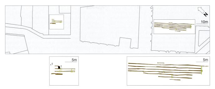
Abb. 8a. Basel BS, Münsterhügel. Holzsubstruktion der dritten, frühkaiserzeitlichen Strasse (H III.3). Korrelation der einzelnen Grabungsaufschlüsse gemäss Abb. 6. Zusätzlich abgebildet: 1 zur Substruktion gehörige Steinpackungen. M 1:1000. Grafik ABBS, A. Lanzicher.
