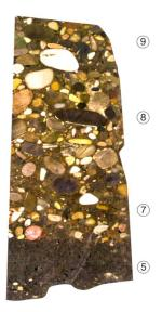
Anschliff Mm 11: 5 einplanierter Wandlehmschutt mit Begehungsspuren; 7 Unterbau dritte Strasse; 8 Fahrbahn dritte Strasse mit Benützungsschicht an Oberkante, 9 Unterbau vierte Strasse.
