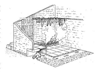
Abb. 1. Räucherkammer mit umlaufendem Heizkanal. Nach Bugnon/Dafflon 2000, 40, Abb. 11.
