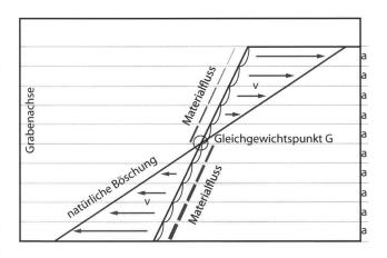
Abb. 11. Sedimentologisches Modell zur Einstellung der natürlichen Böschung.
