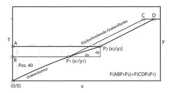
Abb. 14. Sedimentologisches Modell zur Bildung von Pos. 40 durch rückschreitende Erosion der Grabenwange im natürlichen Böschungswinkel.
