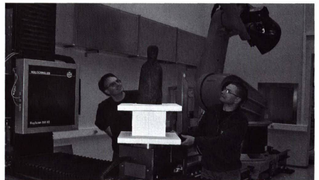
Abb. 3. Scanraum im Audi-Werk Neckarsulm (D). Mit dem orangenen Roboterarm können ganze Karosserien des Audi A8 gescannt werden. Foto AATG, R. Kauermann.
