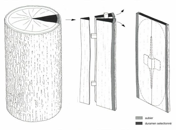
Fig. 7. Bouclier MAR-LT-18649. Représentation schématique des trois phases principales de la fabrication du bouclier. Extraction du quartier choisi pour ses rayons médullaires rectilignes; élimination de la partie centrale de la bille et refente du quartier pour obtenir deux planches; enfin, après ajustement des deux côtés «cœur», collage des deux planches chant contre chant (assemblage à joint vif) aubier à l'extérieur.
