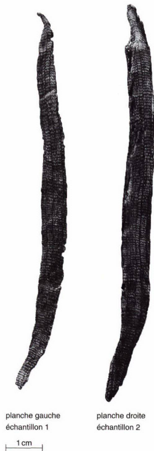
Fig. 8. Bouclier MAR-LT-18649. Sections des deux fragments de chêne appartenant à chaque planche. Celle de gauche a été mesurée en 2006 et celle de droite en 1971. La présence des rayons médullaires sur toute la largeur des deux sections prouve que les planches ont été extraites de la bille là où ces rayons sont droits. Parfaitement plates à l'origine, les deux planches se sont déformées au cours du temps sous la pression des sédiments.
