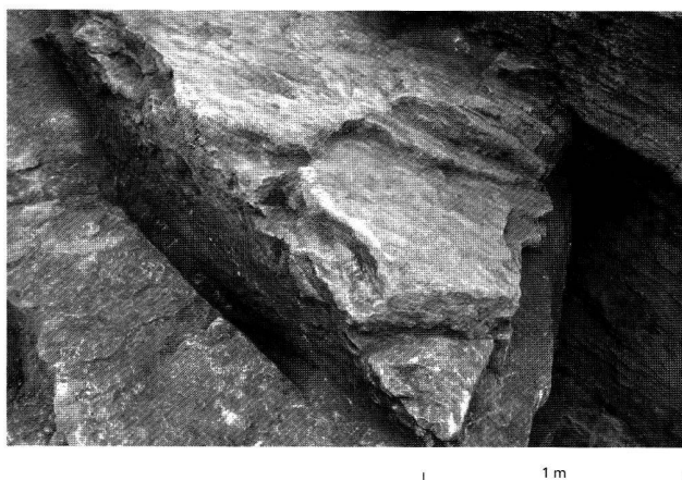
Fig. 7. Tranchée de havage au pied du front de taille 2. Photo Y. André.
