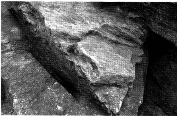
Fig. 7. Tranchée de havage au pied du front de taille 2. Photo Y. André.
