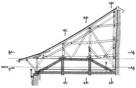
Abb. 48. Thun BE, Gerberngasse 1. Längs- und Querschnitt durch den Dachstuhl von 1405/10. Grauer Raster: Stützkonstruktione von 1964 in der einst durchgehenden Trocknungshalle. M 1:200. Zeichnung ADB, F. Wadsack, AAM.
