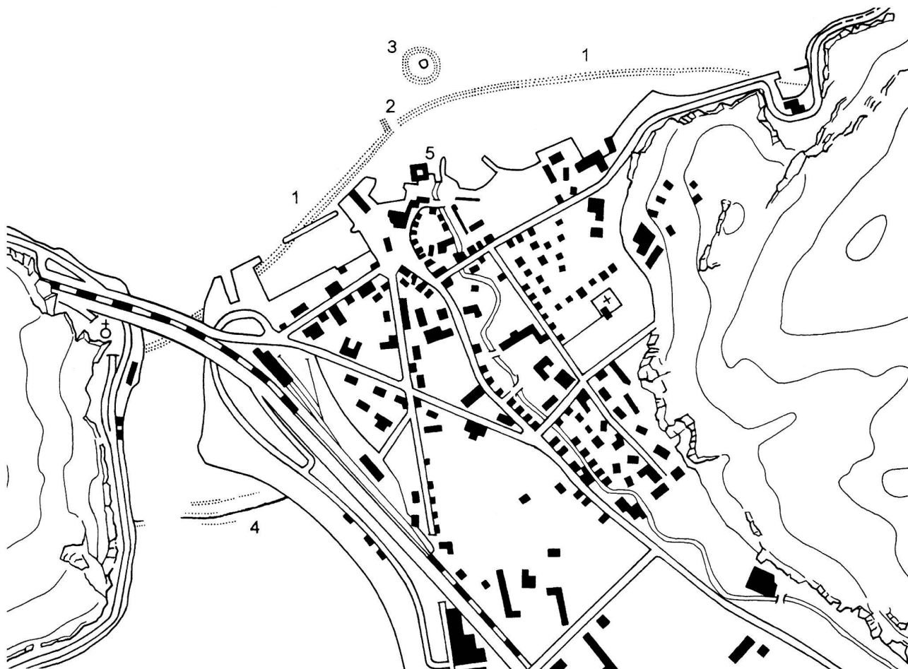
Abb. 47. Stansstad NW, «Teller». Übersicht über die Seesperren. 1 Dreifache Palisadenreihe; 2 Grendel; 3 «Teller»; 4 «Steinwehri»; 5 Schutzturm. Nach J. Obrecht, Château Gaillard 19, 2000, 210, Abb. 8.
