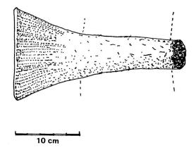
Abb. 13. Rekonstruktion einer Gebläsedüse. Die Länge der Düse ist rein hypothetisch. Die gestrichelten Linien geben einen möglichen Verlauf der Ofenwandlung an. Zeichnung A. Schaer.
