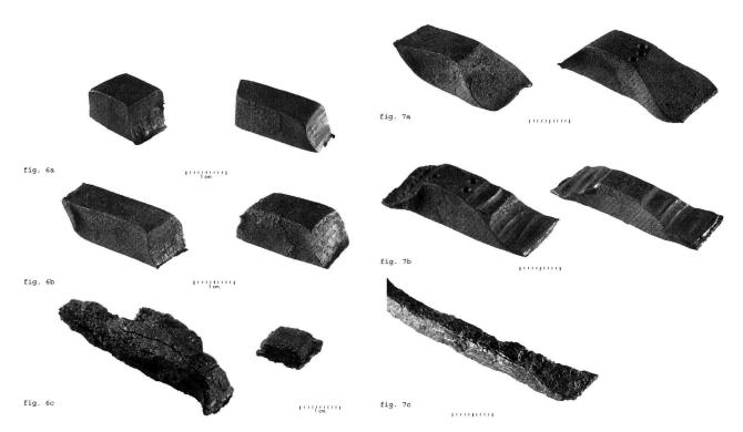
Fig. 6. Exemples de chutes présentant un angle «large». a chutes modernes coupées au ciseau droit; b chutes modernes coupées au tranchet; c chutes antiques (CHA-SA inv. 408, L. 53 mm; CHA-SA inv. 431.1, L. 15 mm). Cliché C. Zaugg, SAC FR.
