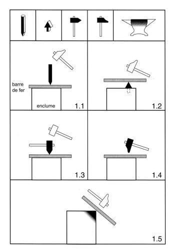
Fig. 1. Outils employés à l'époque romaine pour couper une barre de fer et leur mode d'utilisation. 1 le ciseau droit (Schrotmeissel); 2 le tranchet (Abschröter/Abschrot); 3 la tranche (Schrothammer); 4 la panne du marteau (Finne des Hammers); 5 le bord de l'enclume (Ambosskante). En noir, l'outil employé. Dessin A. Pulido, SAC FR.
