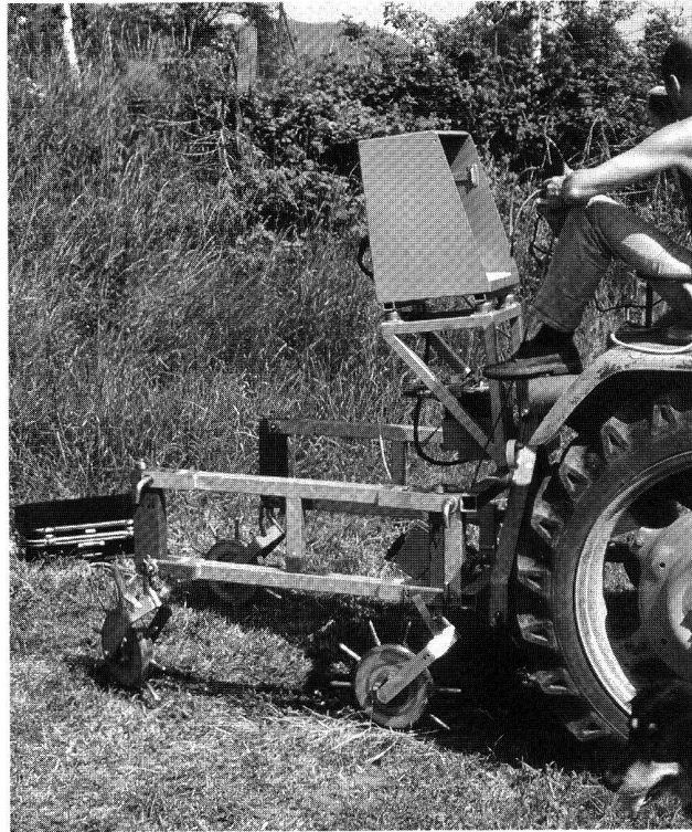
Abb. 11. Aufbau des «square»-Arrays an einem Traktor. Über den Rädern, den Elektroden, ist die Elektronik zu sehen, die vom Beifahrer bedient wird. Photo Jürg Leckebusch KA ZH.
