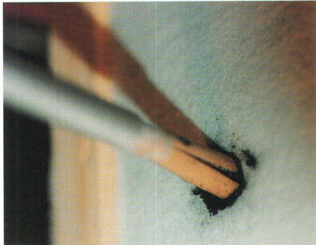
Beim Durchschlag entsteht Wärme, so dass ein Teil des Birkenpechs unter Geruchsbildung abgestreift wird.
