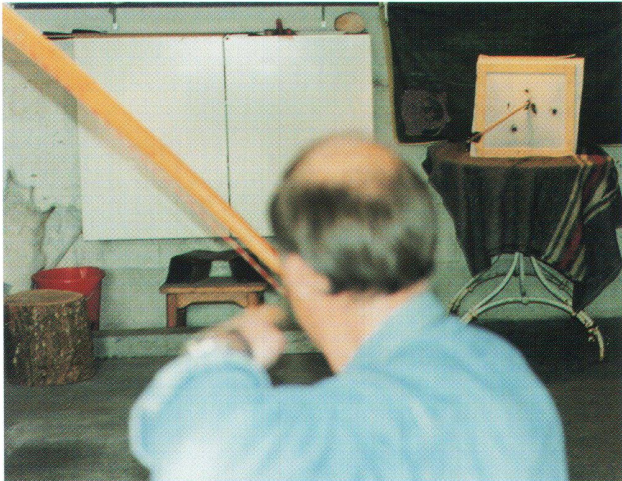
Schiessbetrieb auf 4 m in einem Innenraum. Die Zielbox ist mit einer 3 mm Filz/PVC-Folie bespannt.
