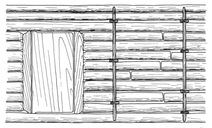
Abb. 6. Schematische Aufsicht und Ansicht einer Wand. Die unterschiedlich langen waagrechten Balken werden durch zwei Blockzangen am Platz gehalten. Die Türöffnung wird durch «Mantelstüden» stabilisiert. Zeichnungen S. van Willigen.
