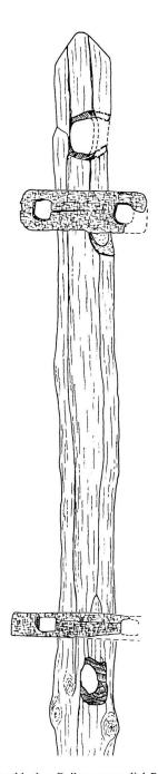
Abb. 4. Zweifach durchlochter Balken, vermutlich Pfette mit darauf projizierten «Zungen» von Blockzangen aus der spätbronzezeitlichen Seeufersiedlung Auvernier-Nord NE. Nach Arnold 1990, fig. 59, verändert.
