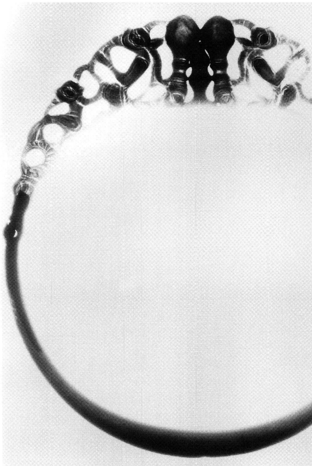
Abb. 2. Röntgenaufnahme des Halsrings E1. Ausschnitt mit Blecheinlage im Bereich des Verschlusses. M 3:4. Photo Eidgen. Materialprüfungsanstalt Dübendorf.
