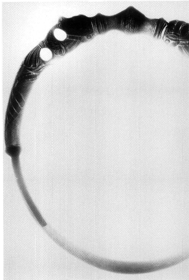
Abb. 3. Röntgenaufnahme des Halsrings E4. Ausschnitt mit Blecheinlage im Bereich der Kugelgelenkverbindung zwischen dem Vorder- und Rückteil des Ringes. M 3:4. Photo Eidgen. Materialprüfungsanstalt Dübendorf.
