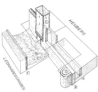
Abb. 29. Basel BS, Leonhardsgraben 47–49. Situationsplan M 1:500 und isometrische Rekonstruktionsskizze der nachgewiesenen Wehrbauten. A Burkhardsche Stadtmauer; B Innere Stadtmauer; C älterer, rechteckiger Wehrturm; Djüngerer, halbrunder Schalenturm; E Stadtgraben; F Gegenmauer. Helles Raster: modern überbaut; dunkles Raster: Stadtgraben; Mauerzüge schwarz: gefunden, grau: ergänzt.
