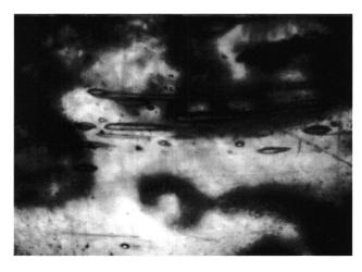
Abb.1. Luftblasen in einer römischen Glasgemme. 30-fache Vergrösserung. Photo H. Diethelm.
