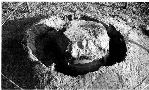
Abb. 11. Während des Abkühlens abgesackte Ascheabdeckung.
