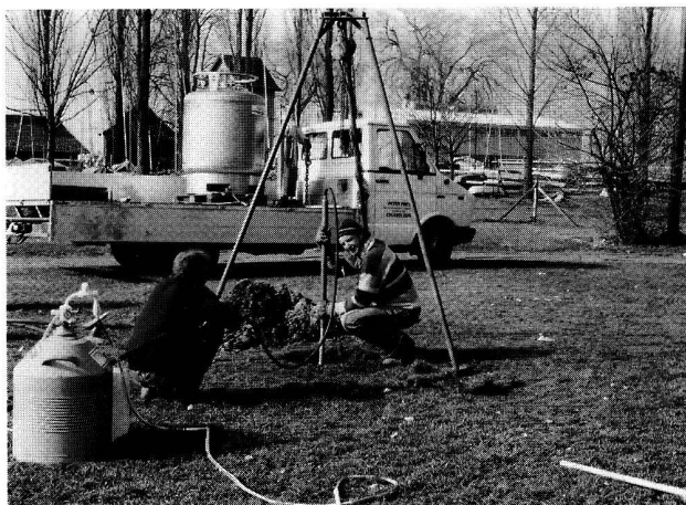
Abb. 14. Zug-Seeufergestaltung. Gefrierkern-Bohrung: Einrammen des Bohrgestänges mit einem Presslufthammer. Das Kühlen des Rohres geschieht mit Flüssigstickstoff aus dem im Vordergrund sichtbaren mobilen Druckgefäss, das beim grossen Tank auf dem Fahrzeug jeweils wieder aufgefüllt werden kann. Das Ziehen des gekühlten Bohrröhres erfolgt anschliessend mit Flaschenzug und Dreibein.
