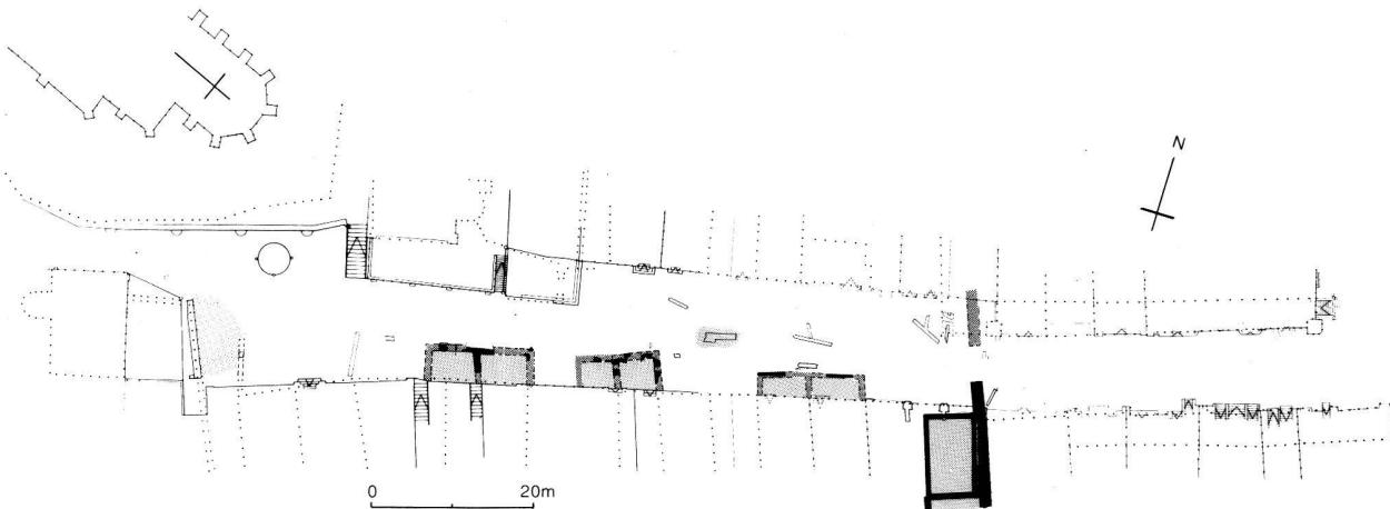
Abb. 33. Burgdorf BE, Kirchbühl. Archäologische Aufschlüsse. Stand Ende 1991. Zähringerische Stadtmauer und Häuser (schwarz und dunkler Raster) sowie festgestellte Innenräume (mittlerer Raster). Im Westen die Pflasterung des mittelalterlichen Beginengässchens (heller Raster). M 1:1000. Zeichnung ADB (M. Leibundgut).
