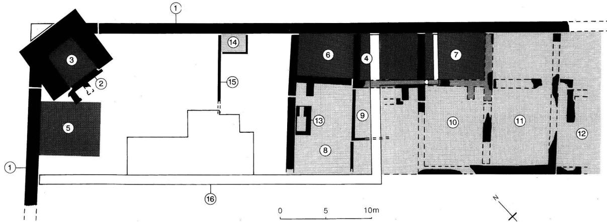
Abb. 34. Burgdorf BE, Kornhaus. Zusammenfassung der archäologischen Befunde 1988–1991. Kernbauten mit dunklem Raster, jüngere mit hellerem; 1: Stadtmauer. 2: Vorgänger des Selbsturmes. 3: Selbsturm. 4: erster Steinbau. 5: Holzbau. 6,7: jüngere Kernbauten. 8,9: Vorderhäuser. 10–12: z.T. parzellenübergreifende Neubauten anstelle älterer Vorderhäuser. 13: Keramikbrennofen. 14: Kellergrube. 15: Hofmauer und 16: Kornhaus von 1770. M 1:400. Zeichnung ADB (R. Baur, Ch. Rungger).
