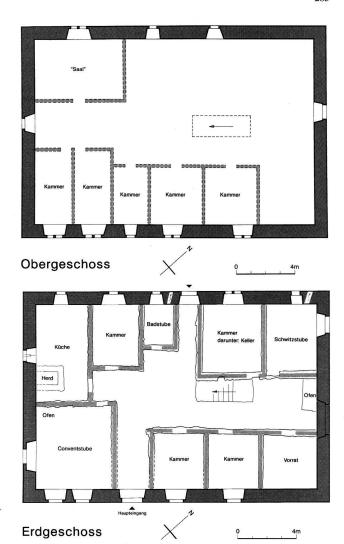
Abb. 38. Burgdorf BE, ehem. Siechenhaus. Grundrisse von Erd- und Obergeschoss mit Bezeichnung der ursprünglichen Raumeinteilung und -funktion. M1:250. Zeichnung M. Stöckli, ADB.
