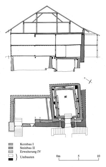
Abb. 40. Hilterfingen BE, Hünibach, Alte Thunstr. 36. Grundriss und Schnitt mit Bauperioden. Zeichnung M. Leibundgut, ADB.
