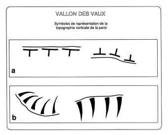
Fig. 43. Symboles graphiques utilisés pour la représentation de la topographie verticale. a) représentation des angles et des dièdres; b) représentation des pentes et des bombements. La partie la plus large indique la zone la plus profonde.
