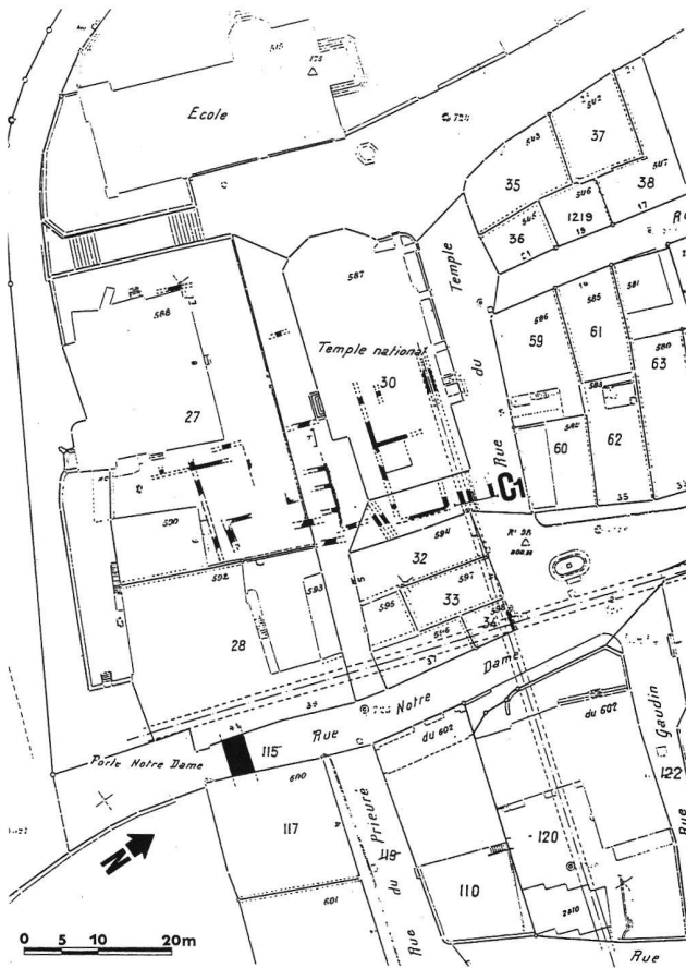
Fig. 15. Nyon VD, Place du Prieuré. Maçonneries romaines et médiévales. C1: voir coupe fig. 16.
