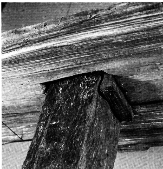
Abb. 4. a: Querschnitt durch Fleckling 516 mit Pfahl 575. b: Längsschnitt durch Fleckling 366 mit Pfahl 367 und von unten eingeschlagenem Keil 980. c: Studioaufnahme derselben Konstruktion: Detailansicht von unten her gesehen.
