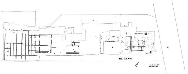
Abb. 39. Augst BL, Steinler. Insula 35 und 36. Übersicht der beiden Holzbauperioden. Ältere nur mit Holz und jüngere in Mischtechnik (Steinunterlagen, auf denen die Holzkonstruktion ruht) ausgeführt.
