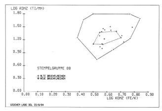
Abb. 15. Chemische Unterschiede zwischen alterierter Oberfläche und frischer Bruchfläche (Stempelgruppe 08): Die Zusammensetzung alter Bruchflächen variiert stärker als der frischere Kern, der Schwerpunkt beider Streufelder ist jedoch ähnlich. Je nach Verwitterungsgrad dürften die Grössenunterschiede der Streufelder variieren.
