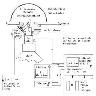
Abb. 9. Aufbau einer EDS-XFA-Anlage, schematisch.
