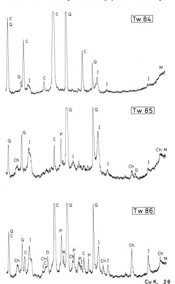
Abb. 11: Röntgendiffraktogramme der Rohtone aus der Umgebung und dem Cortaillod von Twann. TW 84 = Hauterivien-Mergel, Tw 85 und 86 = Lehmlinsen aus dem Cortaillod-Horizont. C = Calcit, Ch = Chlorit, D = Dolomit, G = Gips, I = Illit, M = Montmorillonit, P = Plagioklas, O = Ouarz
