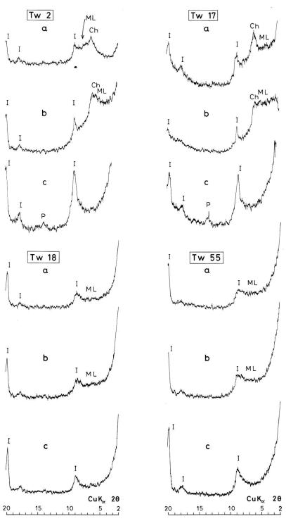
Abb. 10: Ausgewählte Texturpräparate der vier Scherbengruppen aus Twann, a= normales, lufttrockenes Präparat, b= glykoliertes Präparat (60°C/24h), c= gebranntes Präparat (550°C/lh). Ch = Chlorit, I= Illit, ML= Mixed-layer, P= Plagioklas.
