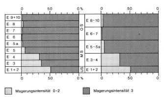
Abb. 14: Magerungsintensität der Cortaillod-Keramik von Twann. 0 keine Magerung sichtbar, 1 Magerung spärlich, 2 Magerung mässig, 3 Magerung stark.
