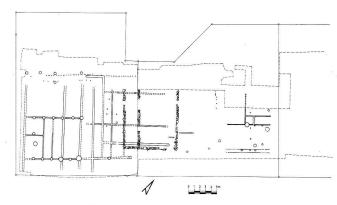
Abb. 48. Augst BL. Insula 35. Zwei übereinander liegende Holzbauphasen. Oben: Konstruktion mit Schwellbalken und eingelassenen Pfosten. Unten: Trockenmauerwerk als Holzbaufundament.
