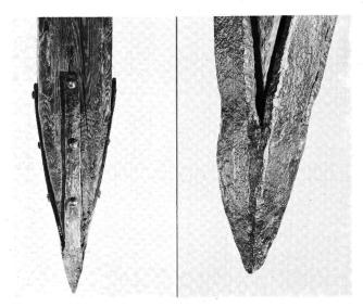
Fig. 29. Bex VD, Pont romain sur le Rhône. Pieu 1, sabot en fer et détail de la pointe forgée. Photos F. Francillon.
