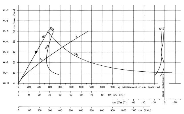
Fig. 16. Courbes hydrostatiques de Bevaix NE 1917.
