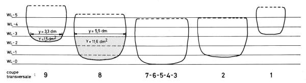
Fig. 13. Coupes transversales nécessaires pour établir les courbes hydrostatiques du bateau (pour leur emplacement cf. fig. 8).
