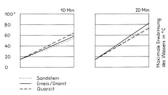
Abb. 10. Versuchsergebnisse mit neuen Hitzesteinen. Volumen-Verhältnis von Stein: Wasser = 1:4. Die Steine wurden während 10 resp. 20 min. erhitzt.
