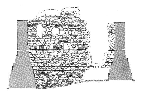
Abb. 16. Amden SG, Strahlegg. Südmauer von innen, zuoberst mittelalterliches Mauerwerk. Weiße Partien von Efeu überdeckt. – Maßstab 1:80.
