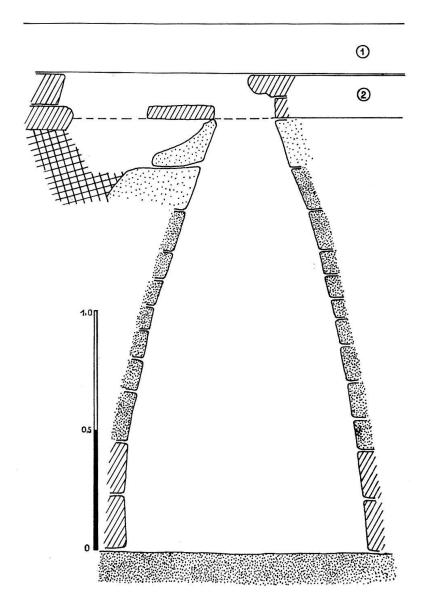
Abb. 60. Pieterlen BE. Kirchenschiff, Schnitt durch den Getreidespeicher. 1 heutiger Kirchenboden, 2 alter Kirchenboden. Strichschraffur: Kalkstein. Punktierung: Tuff. Kreuzschraffur: steiniger Lehm. – Maßstab 1:20.
