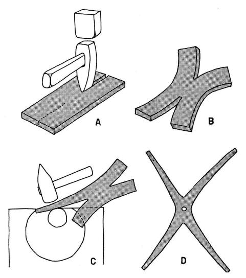
Abb. 1. Der technische Werdegang eines Gitterelementes.
