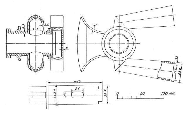
Abb. 5. Umschalthahn aus Petinesca, vervollständigt (vgl. Tafel 7). - Maßstab 1:3.
