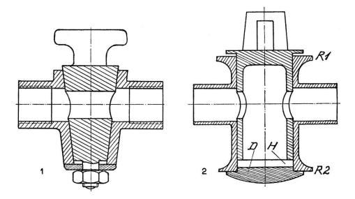
Abb. 1. 1 Schema eines modernen Hahnes. - 2 Schema der römischen Normalkonstruktion.
