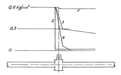
Abb. 2. Druckverlauf im antiken Hahn. 1 Durchgangshahn, 2 Auslaßhahn geschlossen, 3 Auslaßhahn geöffnet, 4 Zapfhahn.
