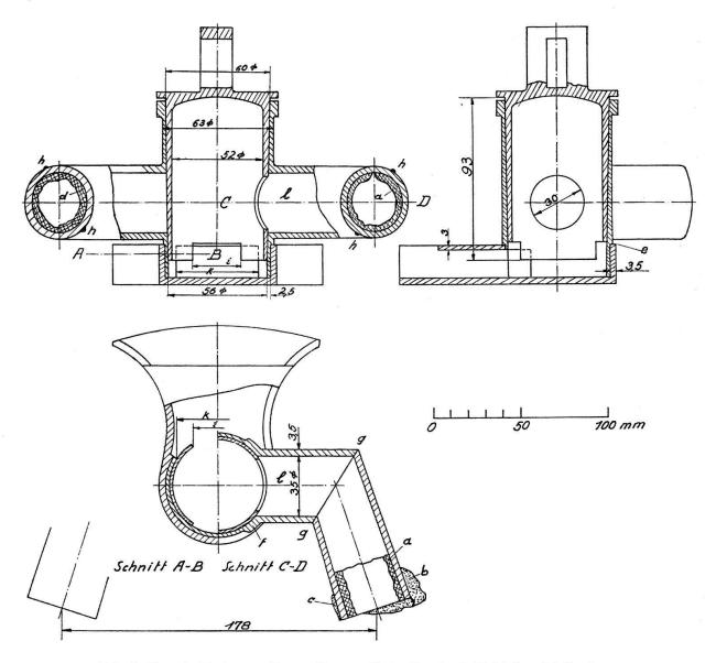
Abb. 6. Umschalthahn aus Rottweil, vervollständigt (vgl. Tafel 8). – Maßstab 1:3.
