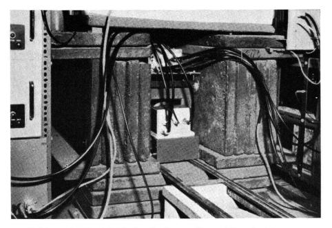
Tafel 11. A. Zwei Zählrohre in der geöffneten Eisenabschirmung.
