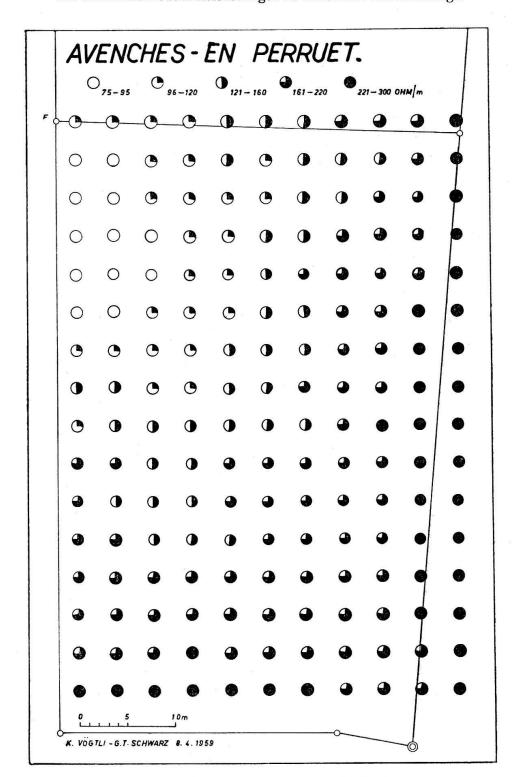
Abb. 1. Geo-elektrische Flächenaufnahme. Maßstab 1:500.
