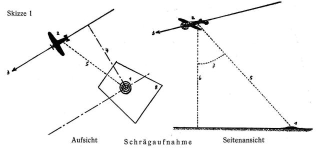
1 Objekt. 2 Flugzeug. 3 Flugrichtung (abhängig vom Sonnenstand). 4 Seitlicher Abstand. 5 Aufnahmerichtung (immer leicht schräg nach hinten, damit der Flügel nicht auf das Bild kommt). 6 Lot (= Flughöhe). 7 Aufnahmewinkel. 8 Aufgenommener Geländeausschnitt (variiert mit Flughöhe und Aufnahmewinkel)
