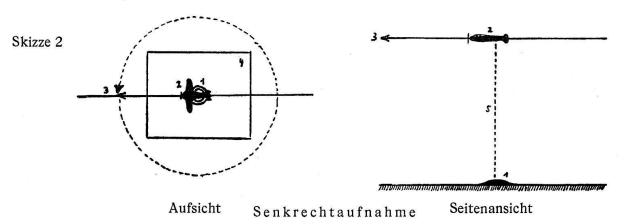
1 Objekt. 2 Flugzeug. 3 Flugrichtung (kann um 360° variieren). 4 Aufgenommener Geländeausschnitt (variiert mit der Flughöhe). 5 Aufnahmerichtung = Lot (= Flughöhe)
