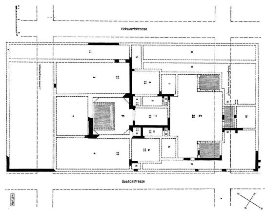
Abb. 16. Augst. Grundriß der Zentralthermen. Ergänzungsversuch (Räume mit vier Punkten sind heizbar)
