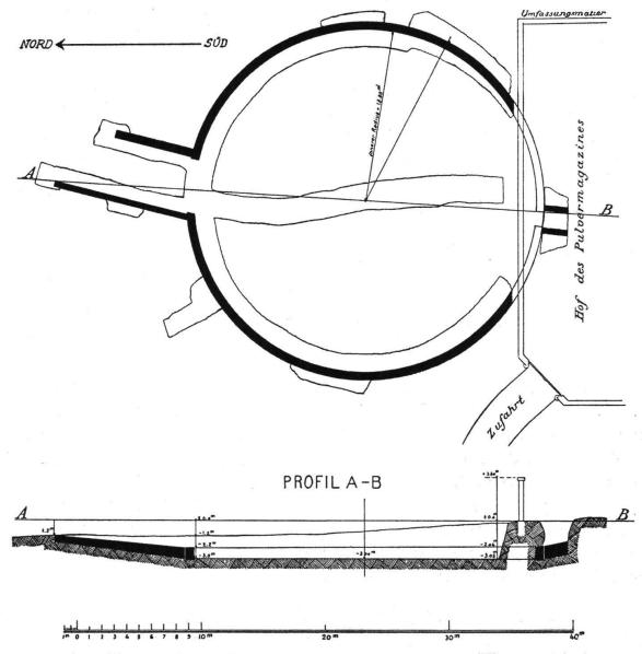
Abb. 25. Bern, Engehalbinsel. Rundbau beim Pulverturm (Wasserspeicher)
