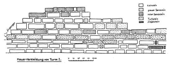
Abb. 14. Wyhlen. Mauerverkleidung von Turm I Klischee aus Bad. Fundberichte 1934
