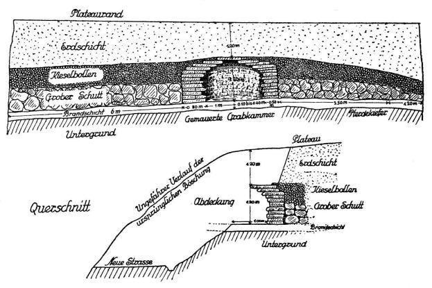
Abb. 3. Donath. Valtiet-Tobel. B. Gr. Längsschnitt und Querschnitt.
